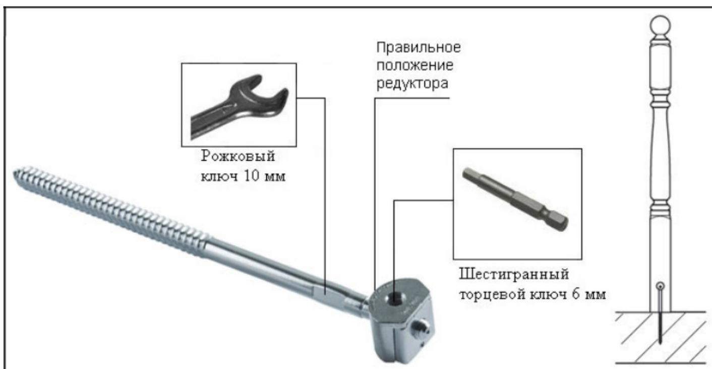
**Внимание!** Редуктор устанавливается на шпильку полукруглой стороной с пазом.
