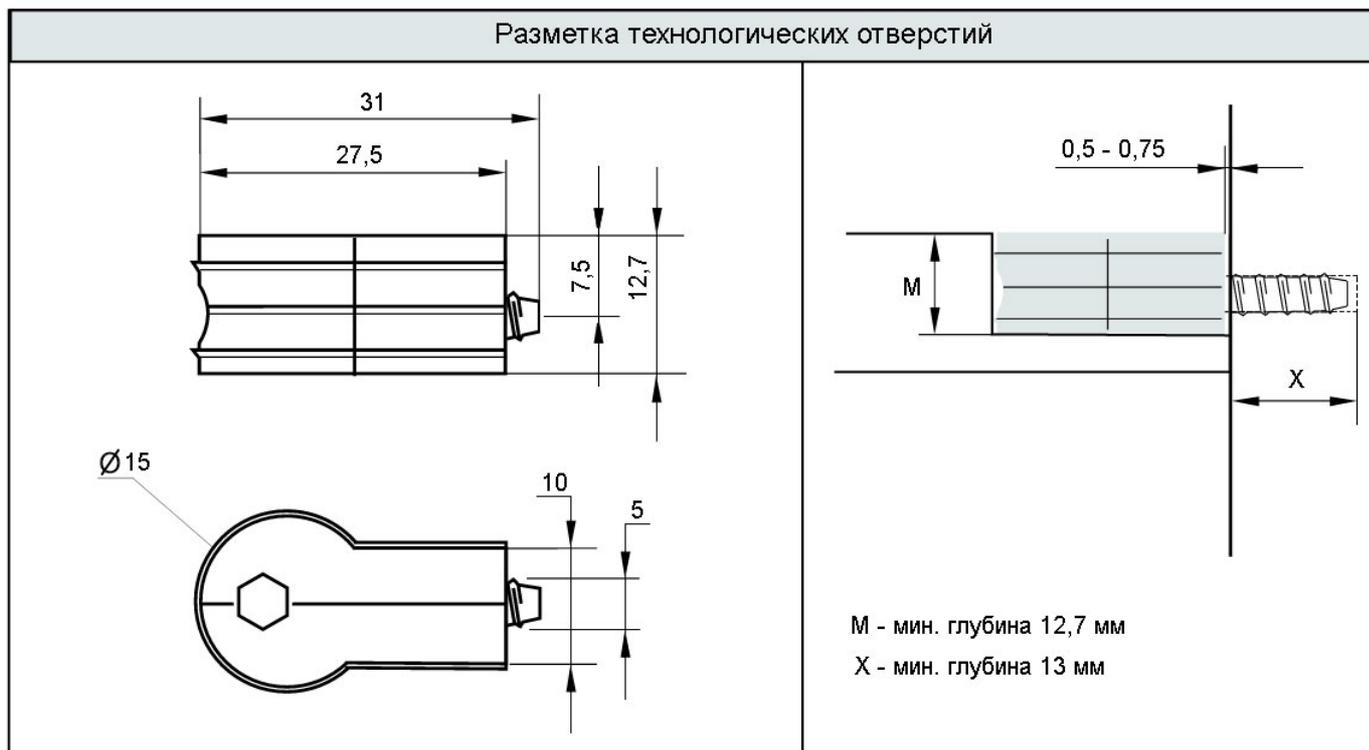
1. Разметьте и сделайте технологические отверстия согласно присадочному чертежу.
